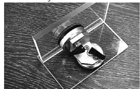
Abb. 9b: Haltevorrichtung mit Saugtellern für Winkelverklebungen
