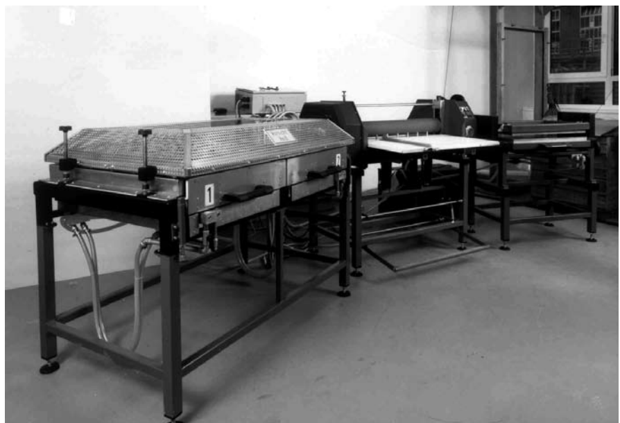
Abb. 31: Gerätesystem zum Verwalzen: Erwärmungsstation, Walzenstuhl, Abkühlstation (von links nach rechts)
